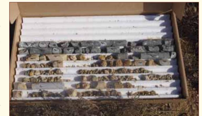
Les échantillons prélevés lors du forage, altérés en surface sains en profondeur.
